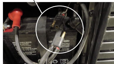
Connecter le faisceau de câbles
