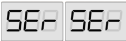
Fig. 32: SERVICE mode enabled
