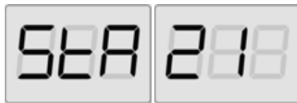
Fig.21: Visualizzazione squilibrio statico abilitata. Il display di destra indica l'entità dello squilibrio statico
