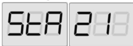
Fig.21 : Affichage balourd statique activé. L'affichage de droite montre la valeur du balourd statique
