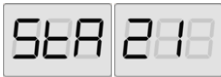
Fig.21: Visualización del desequilibrio estático activada. La pantalla derecha muestra la magnitud del desequilibrio estático
