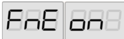
Fig. 28 : Activation de l'affichage des balourds en haute résolution
