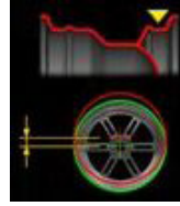
radialer Seitenschlag des Sitzes des externen Reifenwulsts (1. Grundschwingung);
