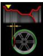
radialer Seitenschlag des Sitzes des internen Reifenwulsts (Spitze-Spitze);
