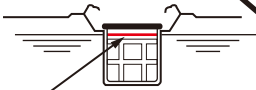
Fuel level indicator Indicador de nivel de combustible Indicateur de niveau de carburant
