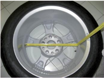
Figura F3.3.1 Ejemplo de medición manual del diámetro externo ( da2 ) de la rueda con Tipo de Programa ALS1/ALS2
